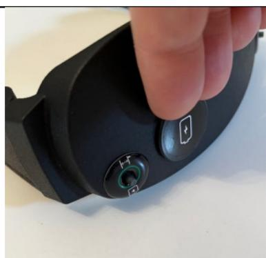
Pour desserrer le bouchon qui ferme l'accès à la pile, positionne les ongles de deux doigts dans l'espace entre le bouchon et les lunettes, comme sur la photo.
