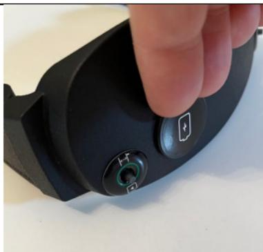
Para aflojar el tapón que cierra el acceso a la batería, coloque las uñas de dos dedos en el hueco entre el tapón y las gafas como en la imagen.
