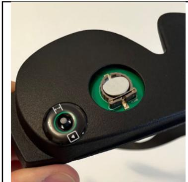
Para insertar la nueva pila de botón tipo CR 1220 3V, sujeté las gafas horizontalmente como se muestra en la imagen y coloque la pila de botón sin apretar en el soporte de la pila de botón; el contacto positivo hacia arriba.
