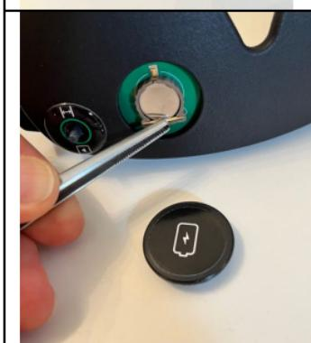
Die Knopfzelle wird von einem quersitzenden Metallstreifen gehalten. Die Batterie springt dann heraus, wenn Sie den Metallstreifen in der Mitte leicht zum Rand biegen. Eine Pinzette ist hilfreich, mit Daumen und Zeigefinger funktioniert es auch.
