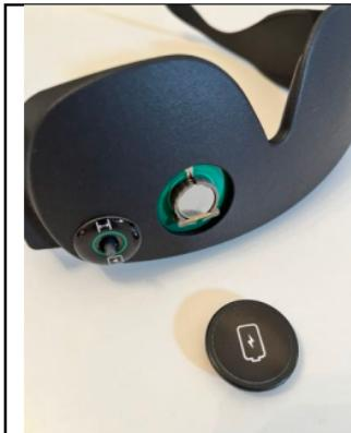
Una vez que haya retirado el tapón, verá la pila de botón de tipo CR 1220 3V (pila de botón de 3,0 voltios DL1220 / CR1220 / CR 1216. Nota: CR 1225 no encaja porque es demasiado gruesa).
